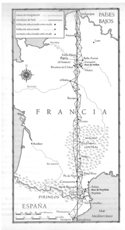
Triangulaciones entre Barcelona y Dunkerque y triángulo Fontana de Oro-Linterna-Montjuic
